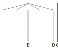
Details Stamm und Nabens: Esche/Teak und Birke/Teak, massiv, mehrlagig wasserfest verleimt; Streben: Esche/Teak massiv; Schirmgestell oberflächenprägniert; Edelstahlkranz; Edelstahlverbindungen; Flaschenzugelemente aus Edelstahl; Überschlagsicherung; Bespannung: Acryltuch - Befestigung in windverstärkter Ausführung mit schnell lösbarren Edelstahlverbindungen
